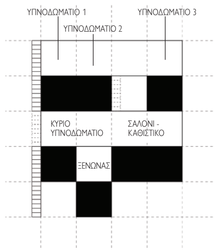
Διάταξη των χώρων, ακολουθώντας τη γεωμετρία του καννάβου, η οποία διακόπτεται στη μια του πλευρά, δημιουργώντας μια ευρύτερη όψη. ©MOLD Architects
