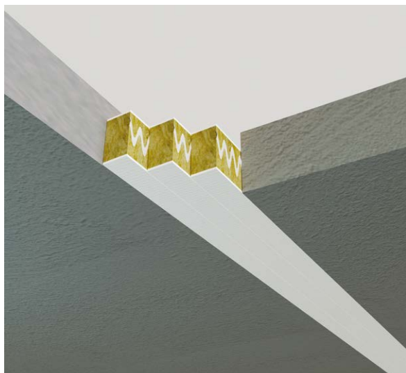
Σφράγιση οικοδομικού αρμού σε πλάκα σκυροδέματος.
