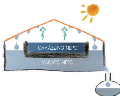
Αφαλάτωση με ηλιακή λίμνη. Το θαλασσινό νερό εξατμίζεται και συλλέγεται καθαρό, αφαλατωμένο νερό με κατάλληλη διάταξη.
