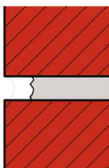
α. Φθαρμένος αρμός που χρειάζεται επιδιόρθωση.
