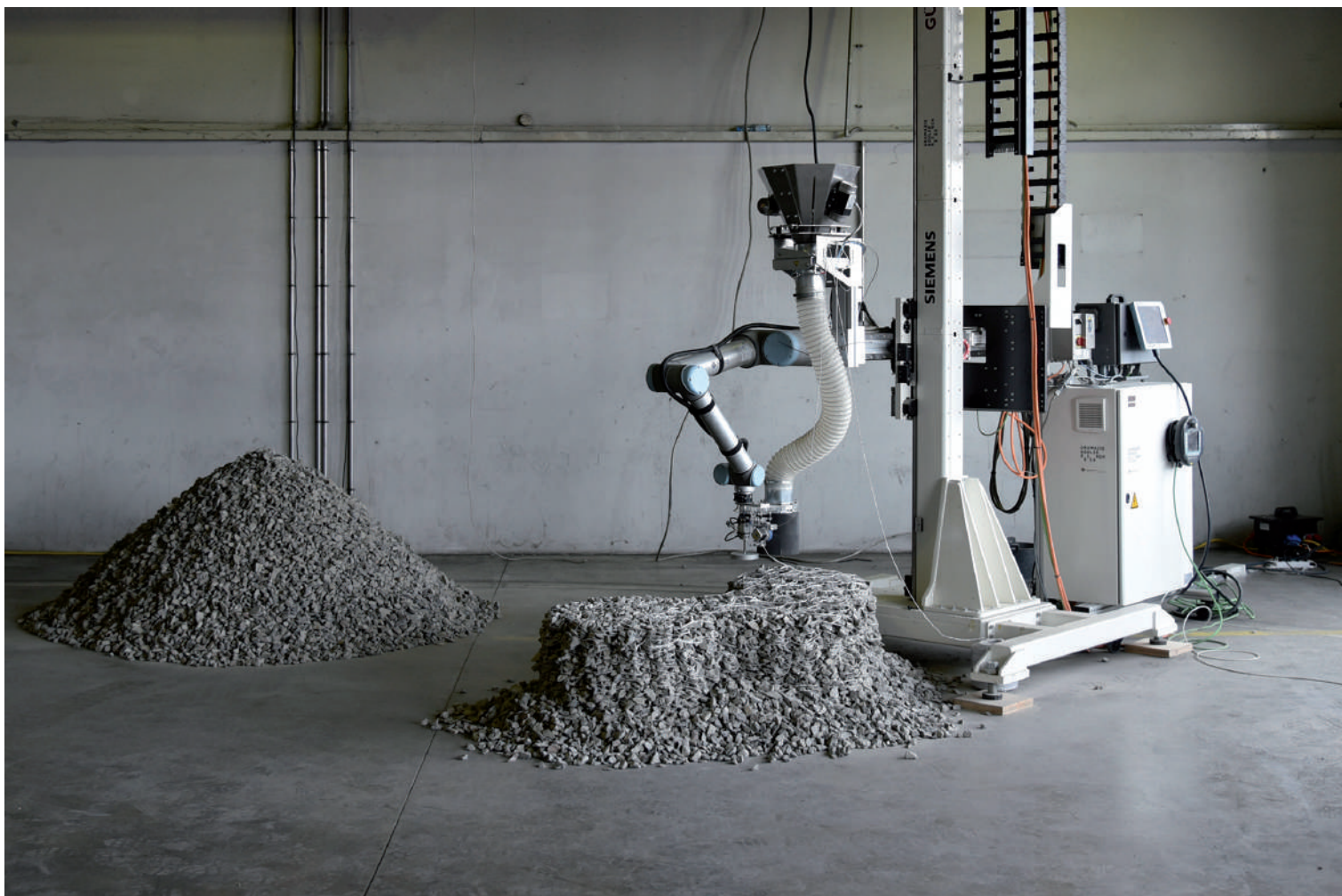
Ερευνητές του ETH Zurich και του MIT δημιούργησαν την εγκατάσταση "Rock Print", η οποία επεκτείνει τη χρήση 3D εκτύπωσης σε αρχιτεκτονικές εφαρμογές, εισάγοντας τη ρομποτική κατασκευή. © Gramazio Kohler Research.
