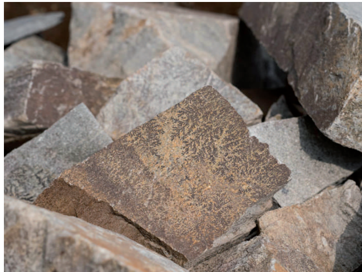
Ανάλογα με το επίπεδο επεξεργασίας τους, οι λίθοι μπορεί να είναι τυκτοί, ημιλαξευτοί ή λαξευτοί.
