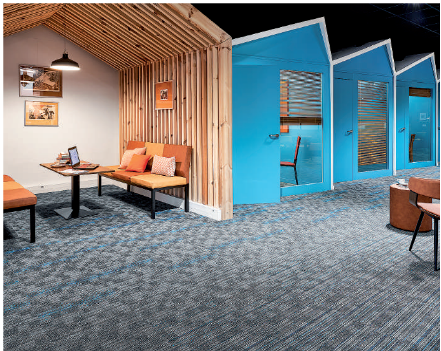
Η επένδυση των δαπέδων με μοκέτες αποτελεί μια σχετικά οικονομική λύση, που μειώνει σε μεγάλο βαθμό το θόρυβο των μετακινήσεων και αυξάνει την απορροφητικότητα του χώρου.
