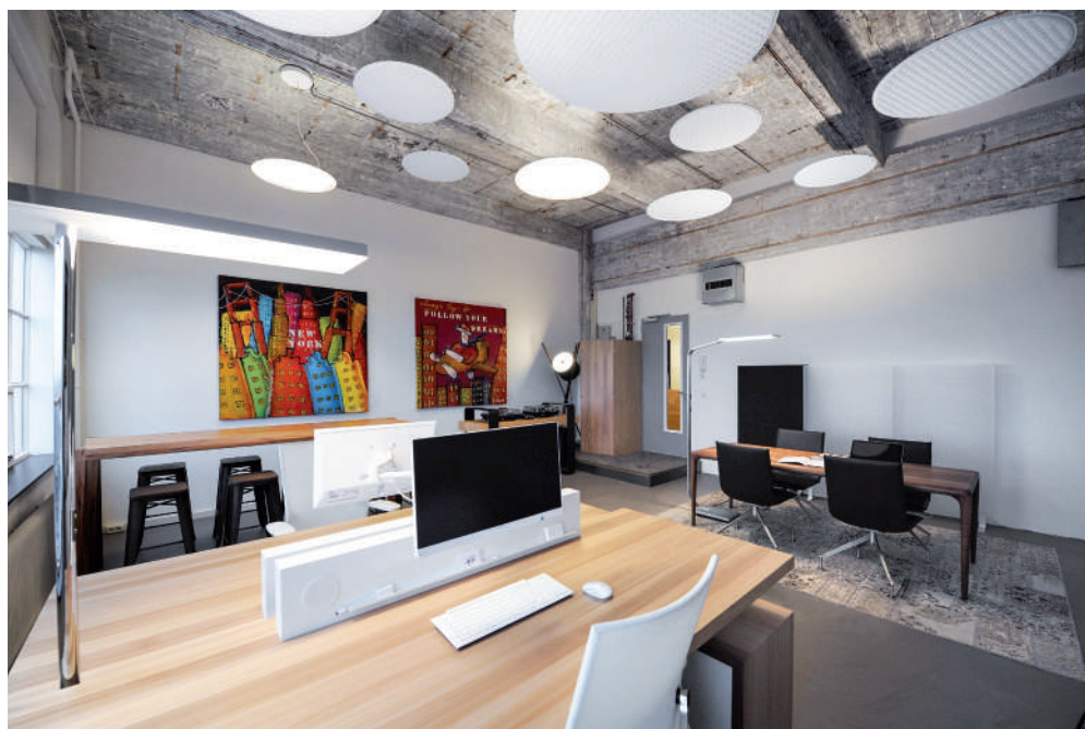
Τα σύγχρονα ακουστικά φωτιστικά λειτουργούν συνεπικουρικά με την οροφή, απορροφώντας τον ήχο και προσφέροντας μια ισορροπημένη φωτιστική λύση.
