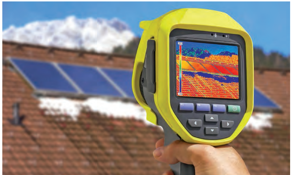
Η θερμικές εικόνες αποτελούν την ακτινογραφία του κτιρίου ως προς τις ενεργειακές απώλειες.
