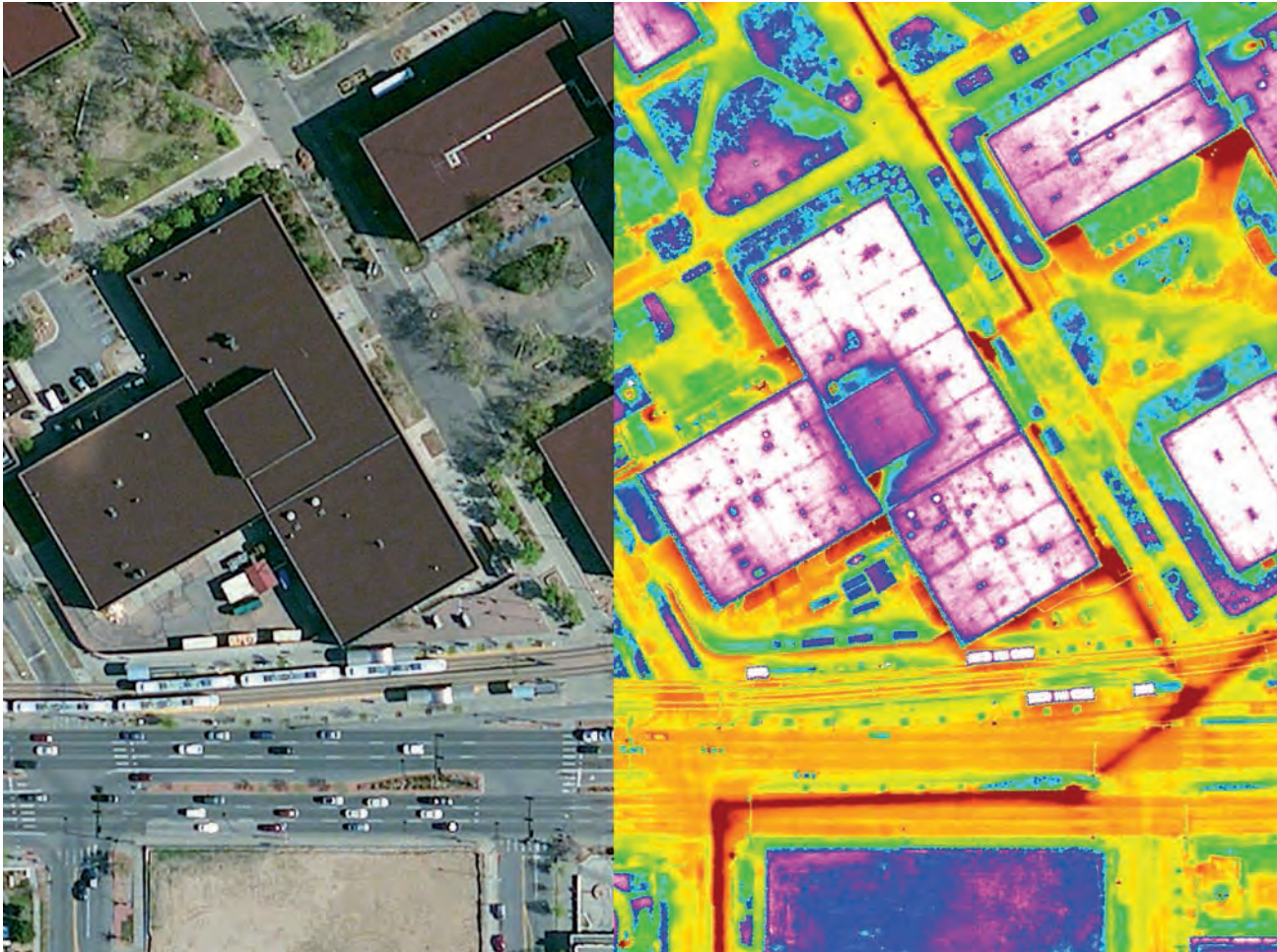
Η χρήση μη επανδρωμένων αεροχημάτων διευκολύνει τη μακροσκοπική θερμική χαρτογράφηση κτιριακών συνόλων.
