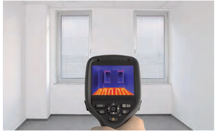
Οι θερμικές εικόνες αποκαλύπτουν "κρυμμένα" δομικά στοιχεία, όταν αυτά βρίσκονται κοντά στην εξεταζόμενη επιφάνεια και διαφοροποιούν τη θερμική ακτινοβολία.
