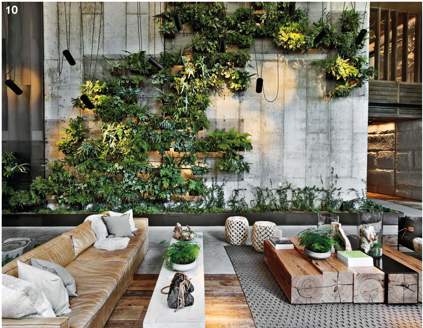
10. Στον χώρο υποδοχής του πολυτελούς ξενοδοχείου "Hotel Brooklyn Bridge" ο φυτεμένος τοίχος, ο οποίος αναπτύσσεται σε ειδικό συρμάτινο πλέγμα, μπορεί να εξελιχθεί και να μεγαλώσει οργανικά, φέρνοντας τη φύση στο εσωτερικό του κτιρίου.
