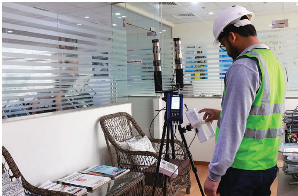
Καταγραφή θερμοφυσικών παραμέτρων σε χώρο γραφείων με ειδικό καταγραφικό εξοπλισμό προσδιορισμού ποιότητας αέρα και άνεσης.
