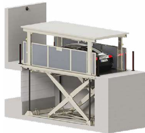
Οι ψαλιδωτοί ανελκυστήρες αποτελούνται από μια πλατφόρμα ανύψωσης, που ανυψώνεται από χιαστί διαγώνιους συνδέσμους υπό την πίεση ενός εμβόλου.
