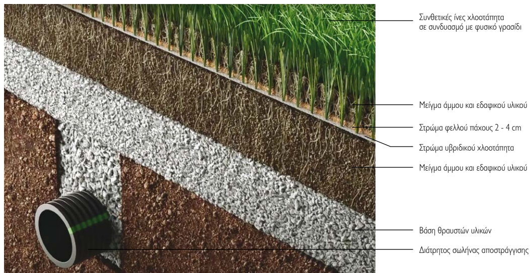
Τομή υβριδικού χλοοτάπητα με σωλήνα αποστράγγισης υδάτων.
