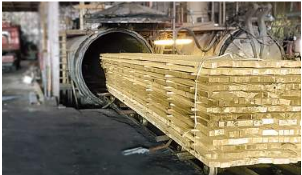
Ο εμποτισμός του ξύλου υπό πίεση πραγματοποιείται με εφαρμογή πίεσης ή/και κενού αέρος σε ειδικές μονάδες, που λέγονται εμποτιστήρια.
