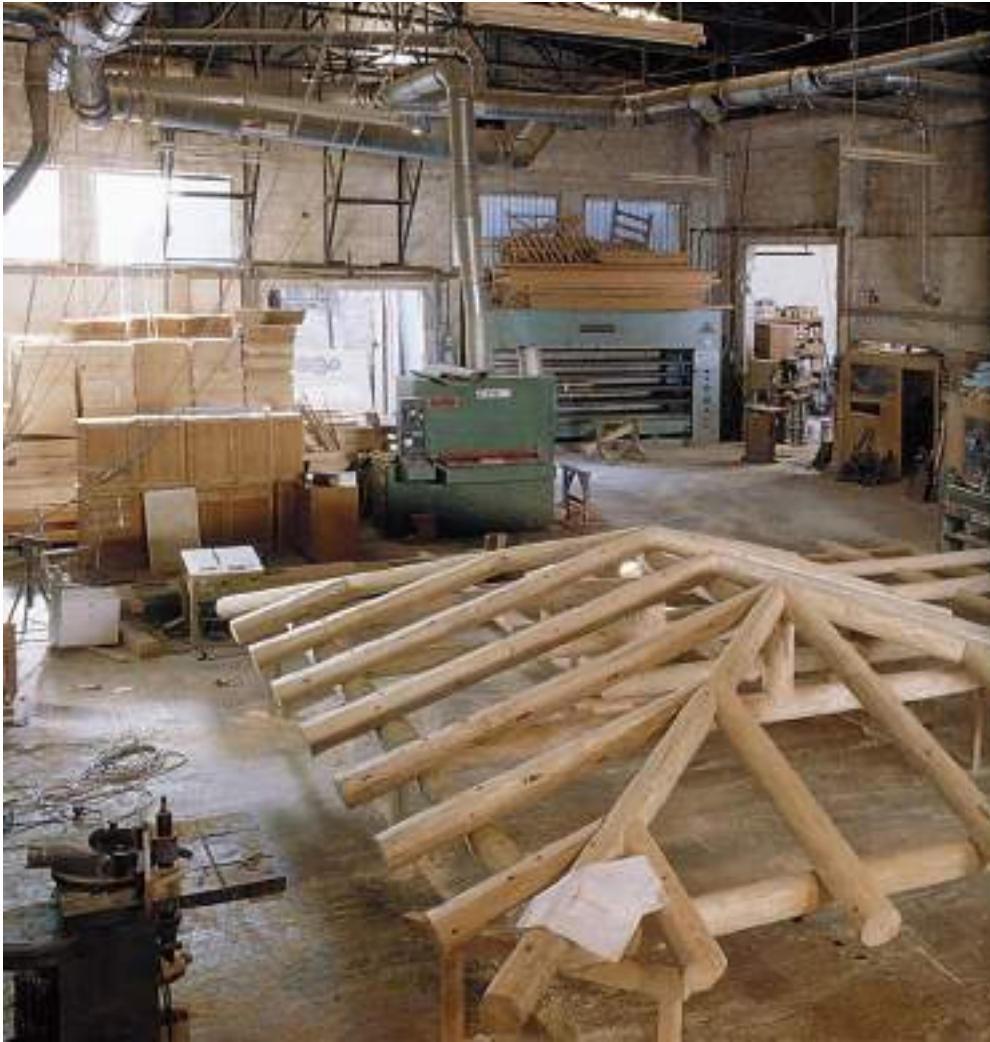
Κατασκευή από ελληνικό κυπαρίσσι, το οποίο είναι φυσικά ανθεκτικό και παρέχει σταθερότητα διαστάσεων, υψηλή διάρκεια στο χρόνο και αντοχή (serwood.gr).
