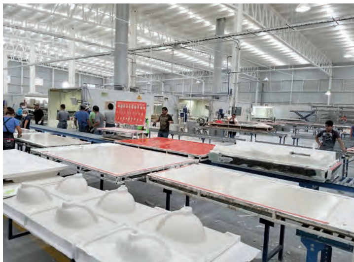
Οι ομογενείς επιφάνειες διαμορφώνονται σε φύλλα ή άλλα σχήματα με χύτευση ή ψεκασμό. Επιπλέον, με τη μέθοδο της θερμοδιαμόρφωσης μπορούν να δημιουργηθούν διαδιάστατα ή τρισδιάστατα σχήματα μεγάλης πολυπλοκότητας.
