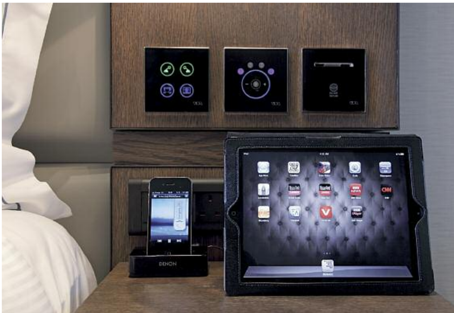
Ο έλεγχος των λειτουργιών του δωματίου γίνεται με την εκμετάλλευση των έξυπνων συσκευών μέσω εγκατάστασης λογισμικού στις συσκευές του χρήστη (πηγή: London's Ecclestone Hotel).
