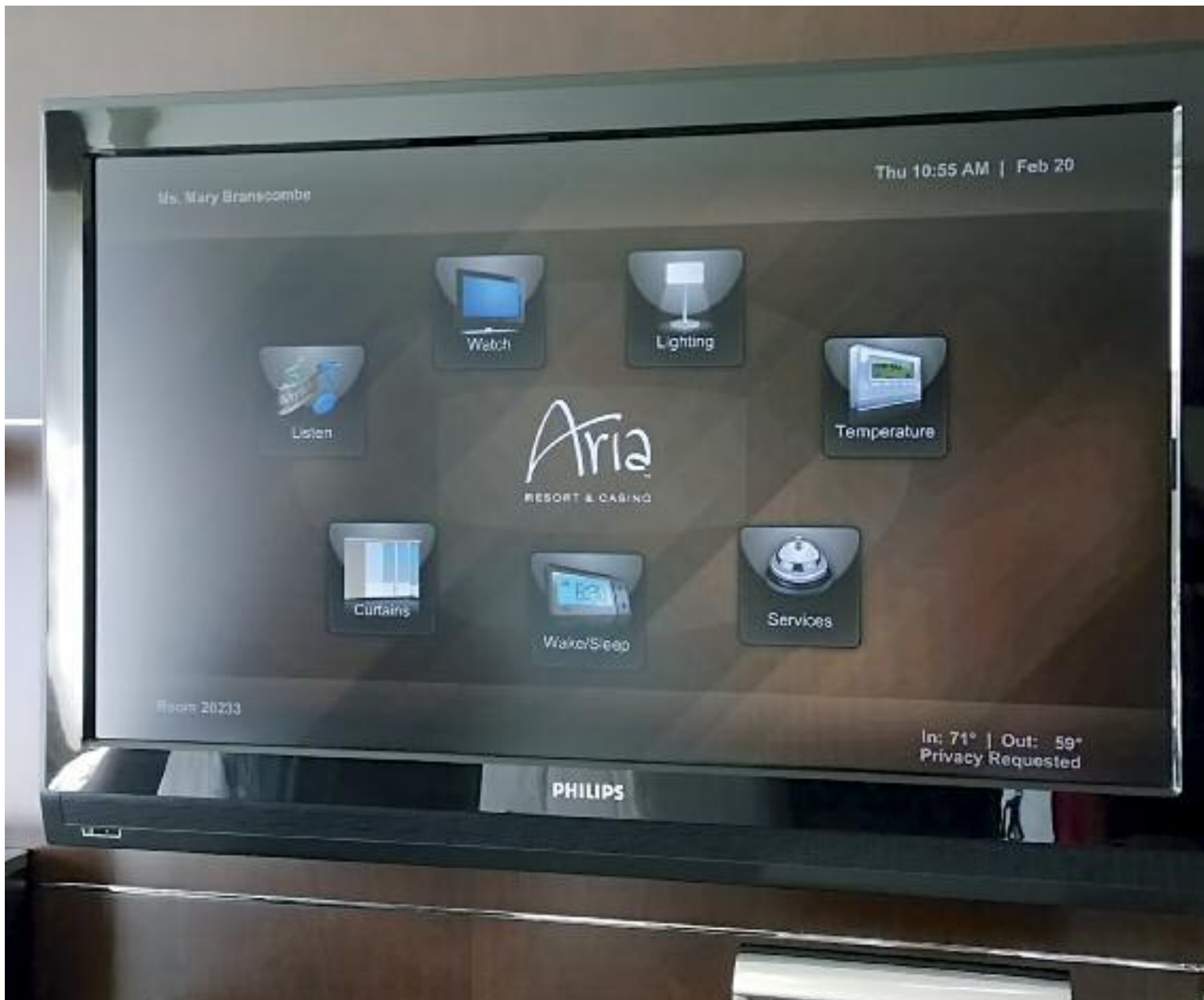
Όλα τα φορτία και οι συσκευές του δωματίου μπορούν να ελέγχονται από ένα αυτοματοποιημένο σύστημα που συνδυάζεται άριστα με το σύστημα πρόσβασης και ασφάλειας, μέσω της εγκατάστασης κατάλληλων συσκευών ελέγχου και δικτύων ασθενών και ισχυρών ρευμάτων (πηγή: https://www.ktechradar.com ).
